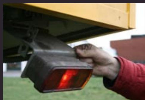
Bei extremen Sandwühlereien lassen sich die Rücklichter nach innen klappen - viel Aufwand für so ein Rücklicht!?
